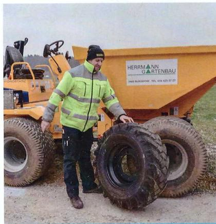
Reduzierter Bodendruck durch Breitreifen.
