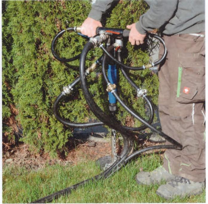
Oben links: Der Kompressor mit Pumpen und Verteileranlage ist das Herzstück der Bodenbelüftung. Oben rechts: Die Belüftungslanze dient zur gleichzeitigen Injektion von Luft, Flüssigkeiten und Feststoffen. Unten links: Dank langem Schlauchsystem ist ein sorgfältiges Arbeiten in bepflanzten Flächen möglich, ohne Schäden zu verursachen. Unten rechts: Der Rasen wird dank Bodenbelüftung kräftig.
